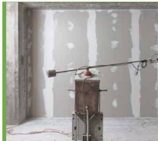
Test de laboratoire des bruits aériens Trocellen faux-mur
